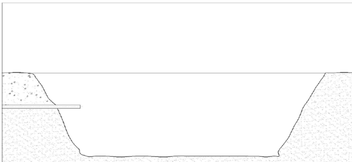
Рис. 2. Схема отрывки котлована.
