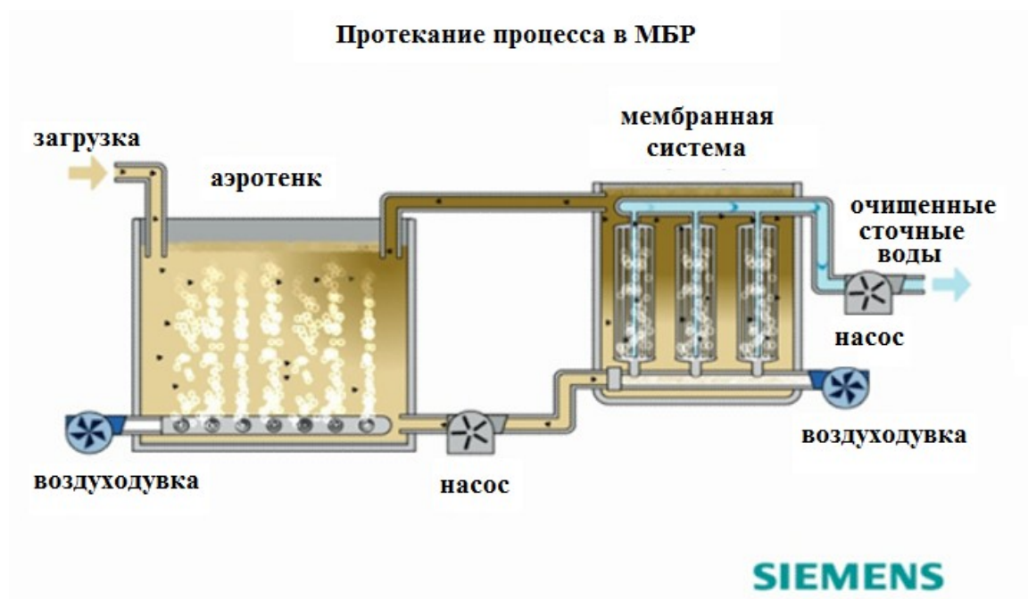
Рисунок 4. Схема мембранного биореактора по версии компании Siemens
