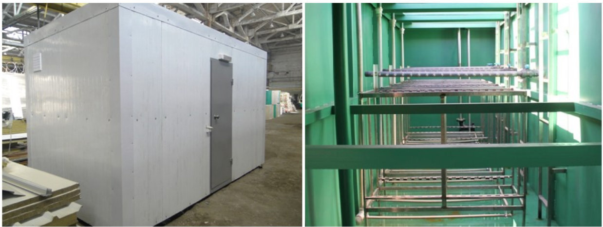
Рис. 2. Изготовление МБР производительностью 200 м 3 /сут для поселка в Московской области на заводе ГК «ЭКОЛОС»
